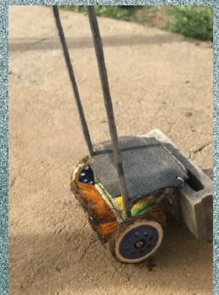
Prototipo final: - Se incorpora 2 escobillones y una tapa
