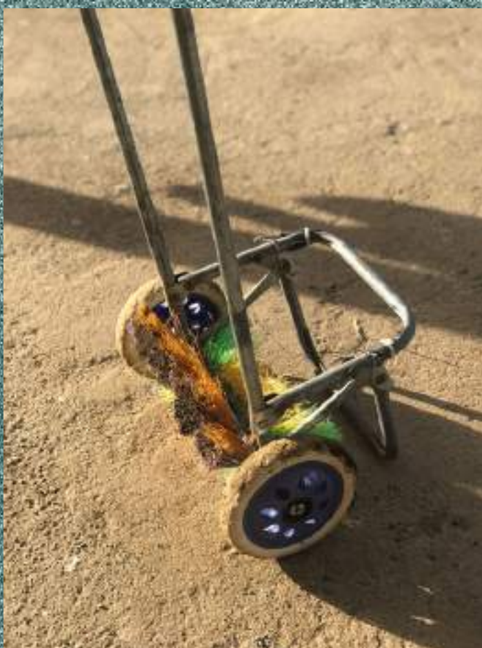
Primer prototipo: - Un carrito que tiene 2 escobillones
